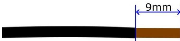
**Figura 2:** Despunte requerido en la bornera de conexiones
