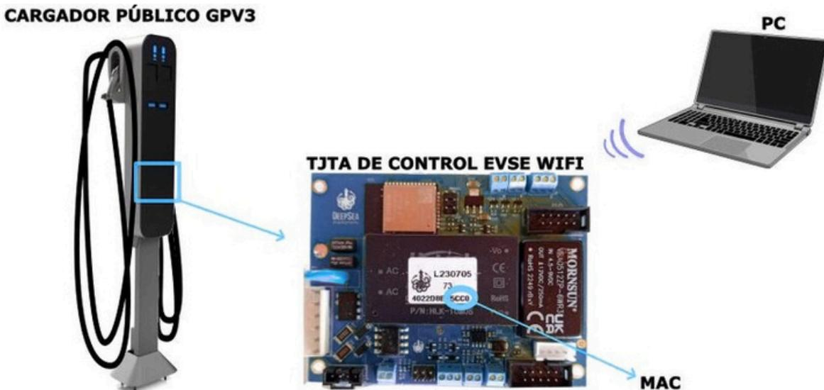
Figura 4. Elementos que participan en el procedimiento de conexión al servidor OCPP
