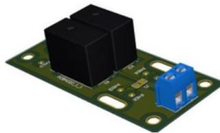
Figura 5. Tarjeta de conexión secuencial.
