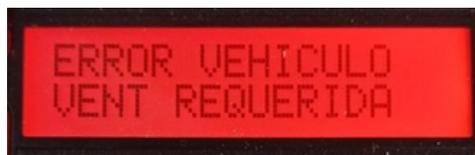
**Figura 3.** Ejemplo de presentación de alarmas en el cargador
